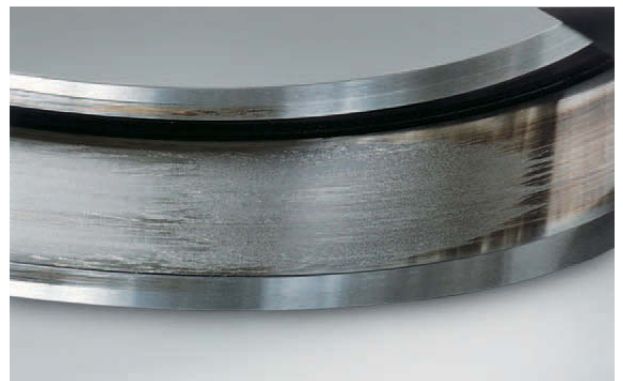
Foto 4.2 Bauteil: Außenring zu Foto 4.1 Symptom: Anschmierungen am Umfang der Laufbahn Ursache: Rollenschlupf durch zu hohe Fettfüllung
