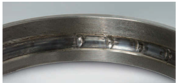
Foto 14.4 Bauteil: Außenring zu Foto 14.3 Symptom: Verfärbung der Laufbahn, Verschmelzung im Wälzkörperabstand Ursache: Zu große Vorspannung
