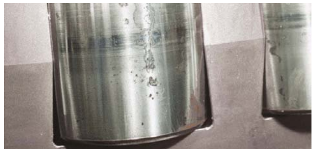
Foto 16.4 Bauteil: Rollen eines Pendelrollenlagers Symptom: Lochfraß im Kontaktbereich der Wälzkörper. Korrodierte Bereiche. Ursache: Feuchtigkeitskondensation während der Lagerung
