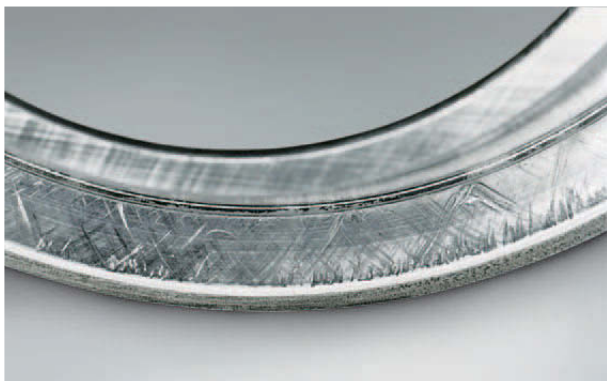
Foto 3.5 Bauteil: Innenring eines Axial-Pendelrollenlagers Symptom: Riefen an der Bordseite des Innenrings Ursache: Eindruck von Fremdkörpern in der Oberfläche und übermäßige Axialbelastung
