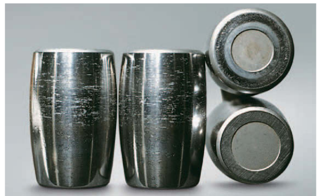
Foto 3.2 Bauteil: Wälzkörper zu Foto 3.1 Symptom: Riefen an der Stirnfläche der Wälzkörper Ursache: Rollenschlupf durch starke Beschleunigung und Verzögerung
