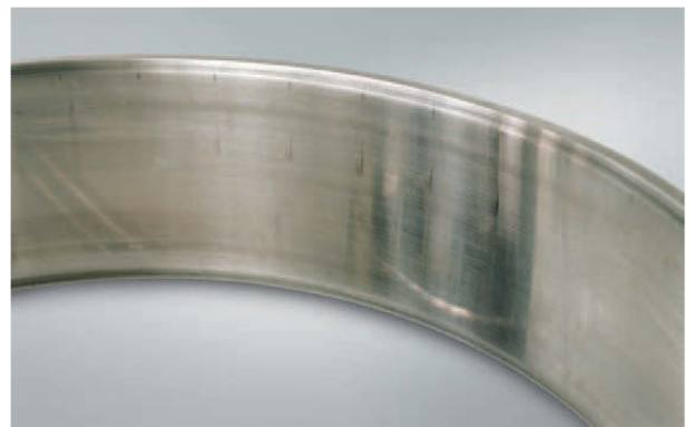
Foto 17.2 Bauteil: Außenring eines zweireihigen Zylinderrollenlagers Symptom: Achsparallele Riefen im Wälzkörperabstand in der Laufbahn Ursache: Fluchtungsfehler zwischen Innen- und Außenring bei der Montage
