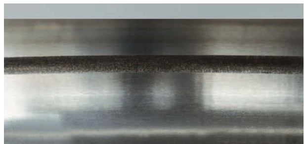
Foto 16.2 Bauteil: Außenring eines Schwenklagers Symptom: Rost in der Laufbahn im Kugelabstand Ursache: Feuchtigkeitskondensation im Stillstand
