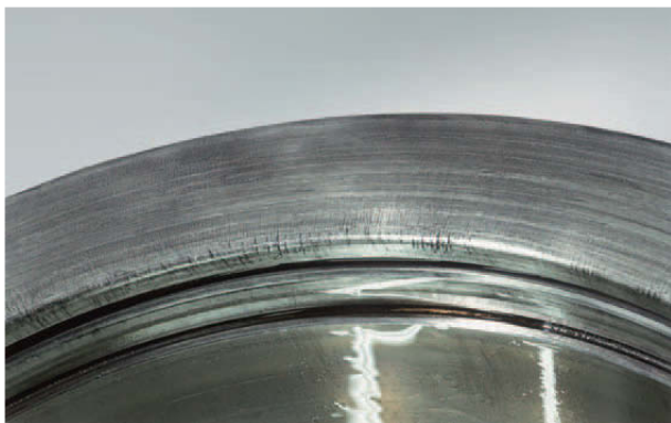
Foto 6.1 Bauteil: Außenring eines zweireihigen Zylinderrollenlagers Symptom: Brandrisse an der Stirnfläche Ursache: Überhitzung durch Reibung zwischen Außenringfläche und Gegenstück
