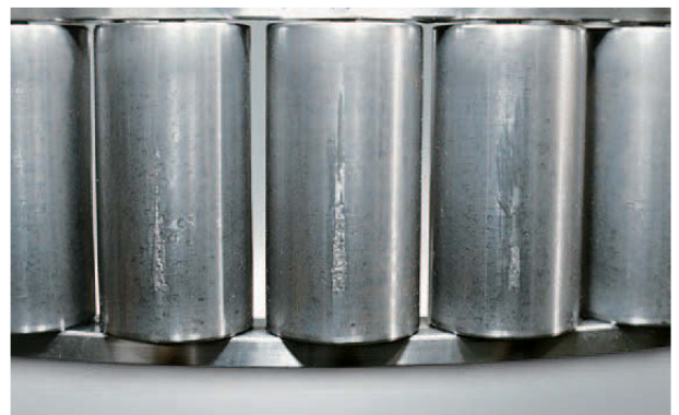
Foto 1.10 Bauteil: Rollen eines Zylinderrollenlagers Symptom: Vorzeitige Abblätterung in axialer Richtung auf der Mantelfläche Ursache: Schürfmarken durch unsachgemäße Montage
