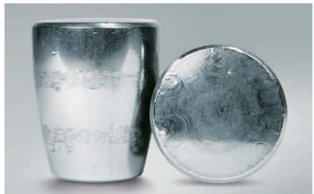
Foto 3.6 Bauteil: Wälzkörper zu Foto 3.5 Symptom: Riefen in der Stirnfläche der Wälzkörper Ursache: Eindruck von Fremdkörpern in der Oberfläche und übermäßige Axialbelastung
