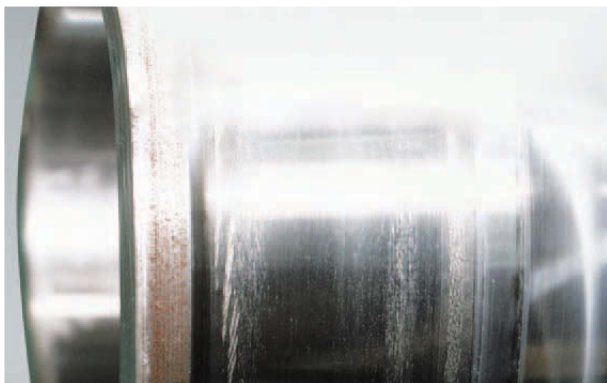
Foto 4.5 Bauteil: Innenring eines Pendelrollenlagers Symptom: Teilweise Anschmierungen am Umfang der Laufbahn Ursache: Mangelschmierung
