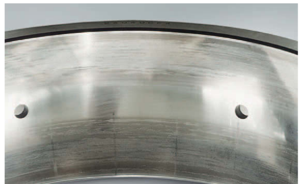
Foto 4.4 Bauteil: Außenring zu Foto 4.3 Symptom: Anschmierungen am Umfang der Laufbahn Ursache: Mangelschmierung
