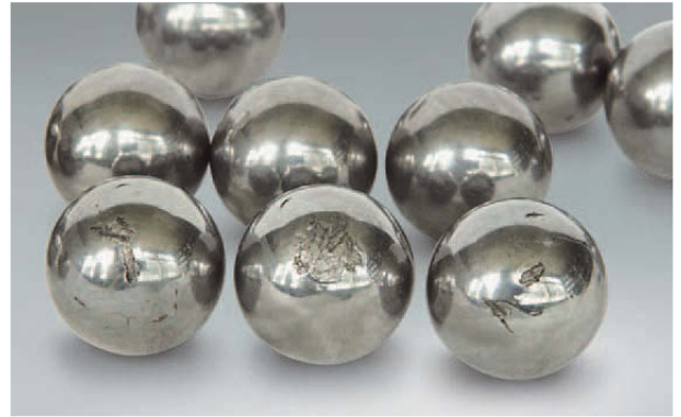
Foto 1.6 Bauteil: Kugeln zu Foto 1.4 Symptom: Abblätterung der Kugeloberfläche Ursache: Eindrücke durch Stoßbelastung im Stillstand
