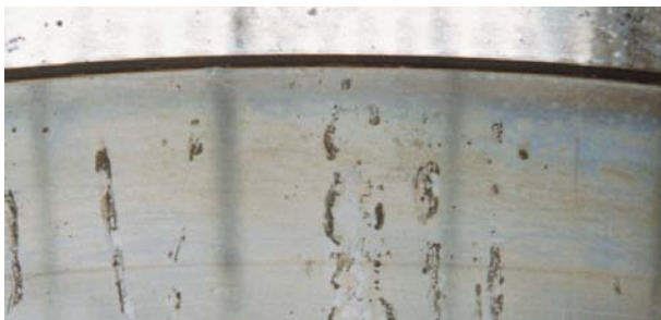
Foto 16.3 Bauteil: Innenring eines Pendelrollenlagers Symptom: Rost in der Laufbahn im Wälzkörperabstand Ursache: Wasser im Schmiermittel
