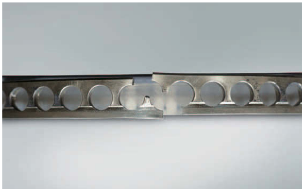
Foto 7.3 Bauteil: Käfig eines Schrägkugellagers Symptom: Bruch des Messingmassivkäfigs
