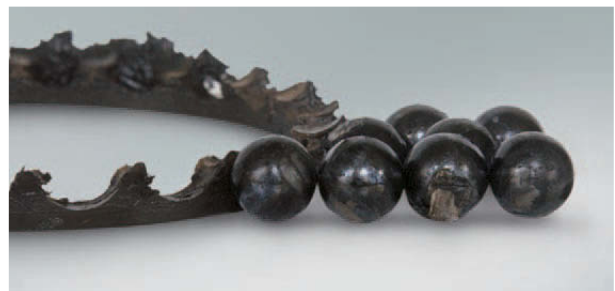
Foto 14.5 Bauteil: Kugeln und Käfig zu Foto 14.3 Symptom: Geschmolzener Käfig, Kugeln verfärbt und geschmolzen Ursache: Zu große Vorspannung
