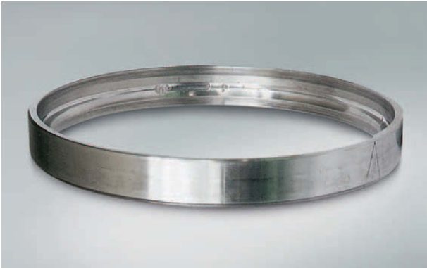
Foto 1.5 Bauteil: Außenring zu Foto 1.4 Symptom: Abblätterung der Laufbahn im Kugelabstand Ursache: Eindrücke durch Stoßbelastung im Stillstand
