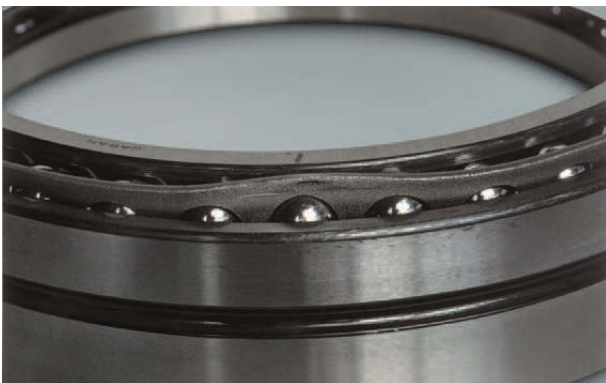
Foto 7.5 Bauteil: Käfig eines Schrägkugellagers Symptom: Verformung des Stahlblechkäfigs Ursache: Stoßbelastung aufgrund unsachgemäßer Handhabung
