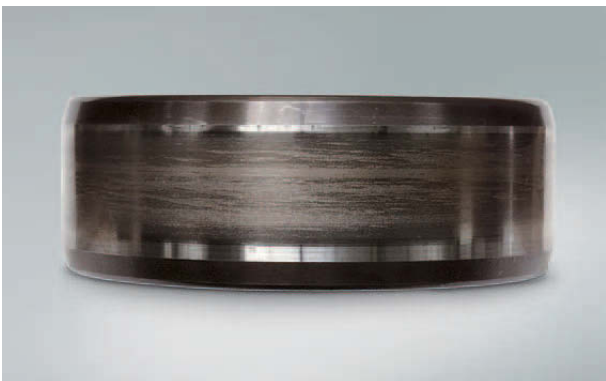
Foto 4.1 Bauteil: Innenring eines Zylinderrollenlagers Symptom: Anschmierungen am Umfang der Laufbahn Ursache: Rollenschlupf durch zu hohe Fettfüllung
