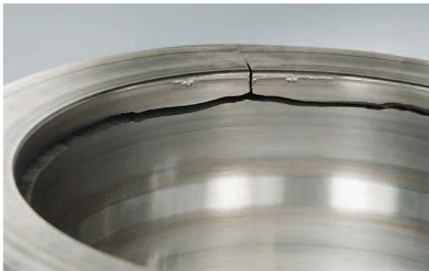
Foto 6.3 Bauteil: Außenring eines zweireihigen Zylinderrollenlagers Symptom: Risse, ausgehend vom Schaden in der Laufbahn, die sich in Achs- und Umfangsrichtung ausbreiten Ursache: Abblätterung in der Laufbahn durch Stoßbelastung
