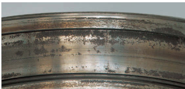
Foto 16.1 Bauteil: Außenring eines Zylinderrollenlagers Symptom: Rost an den Stirnflächen der Borde und an der Laufbahn Ursache: Mangelschmierung durch Eindringen von Wasser
