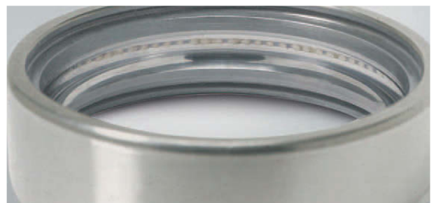
Foto 15.6 Bauteil: Außenring eines Rillenkugellagers Symptom: Riffelungen an der Laufbahn (Durchgang von hochfrequentem Strom)
