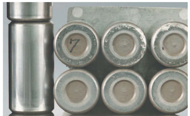
Foto 3.4 Bauteil: Rollen eines zweireihigen Zylinderrollenlagers Symptom: Riefen in der Stirnfläche der Wälzkörper Ursache: Mangelschmierung und übermäßige Axialbelastung
