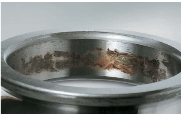
Foto 11.1 Bauteil: Innenring eines Rillenkugellagers Symptom: Passungsrost auf der Bohrungsfläche Ursache: Schwingung
