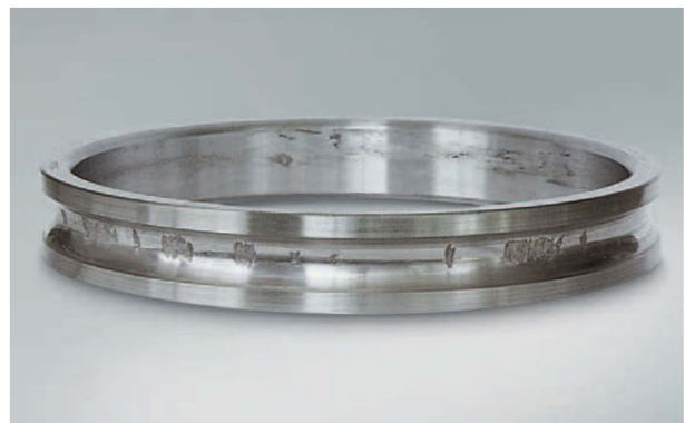
Foto 1.4 Bauteil: Innenring eines Schrägkugellagers Symptom: Abblätterung der Laufbahn im Kugelabstand Ursache: Eindrücke durch Stoßbelastung im Stillstand
