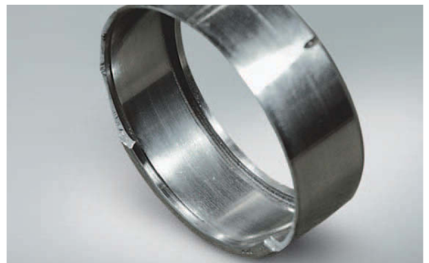
Foto 5.4 Bauteil: Außenring eines Nadellagers Symptom: Bruch des Außenringbords Ursache: Schränken der Rolle aufgrund übermäßiger Belastung (Nadelrollen sind im Verhältnis zu ihrem Durchmesser sehr lang. Bei übermäßiger oder ungleichmäßiger Belastung schränken die Rollen und drücken gegen die Borde.)
