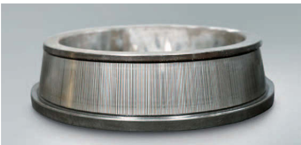
Foto 15.1 Bauteil: Innenring eines Kegelrollenlagers Symptom: Linienförmige Korrosion auf der Laufbahn
