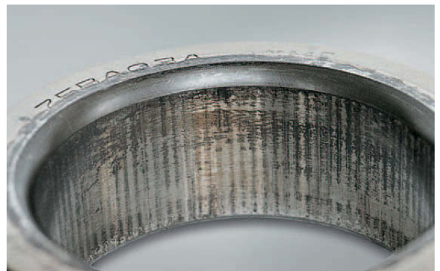
Foto 11.2 Bauteil: Innenring eines Schrägkugellagers Symptom: Starker Passungsrost am gesamten Umfang der Bohrungsfläche Ursache: Unzureichende Passung
