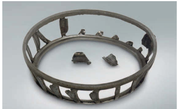
Foto 7.4 Bauteil: Käfig eines Kegelrollenlagers Symptom: Stegbrüche des Stahlblechkäfigs
