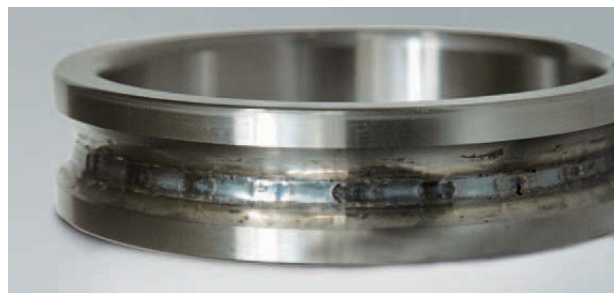
Foto 14.3 Bauteil: Innenring eines Schrägkugellagers Symptom: Verfärbung der Laufbahn, Verschmelzung im Wälzkörperabstand Ursache: Zu große Vorspannung
