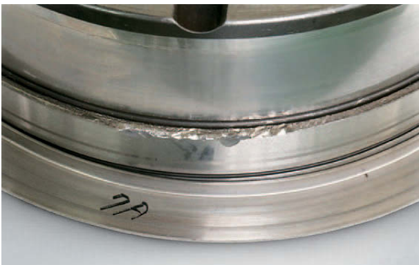
Foto 5.1 Bauteil: Innenring eines zweireihigen Zylinderrollenlagers Symptom: Ausbrüche am Mittelbord Ursache: Übermäßige Belastung beim Einbau
