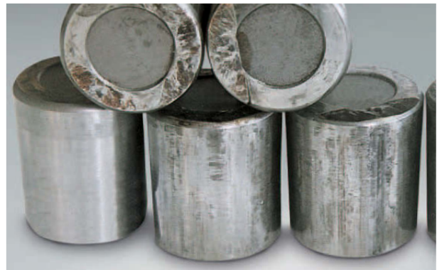
Foto 10.4 Bauteil: Kegelrollen zu Foto 10.3 Symptom: Stufenförmige Abnutzung an den Stirnflächen der Rollen Ursache: Fortschreitendes Fressen durch übermäßige Belastung im Stillstand
