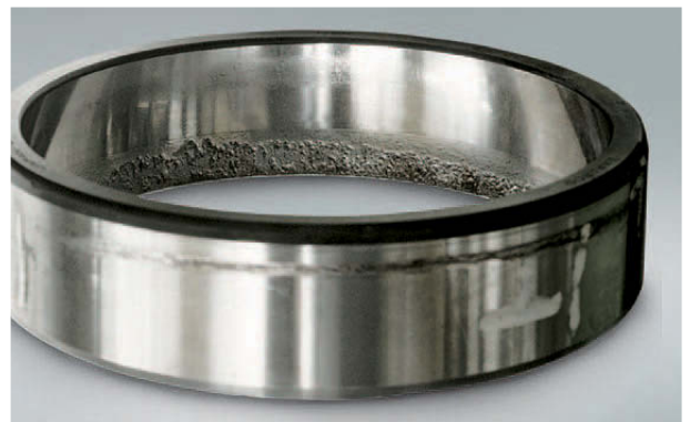
Foto 1.8 Bauteil: Außenring zu Foto 1.7 Symptom: Abblätterung an nur einer Laufbahn am gesamten Umfang Ursache: Übermäßige Axialbelastung
