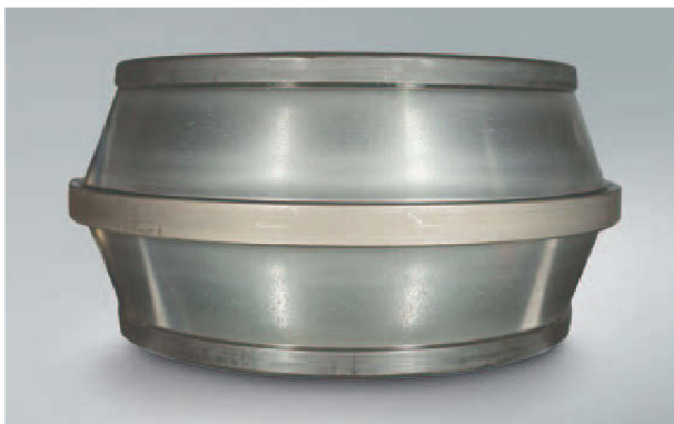
Foto 8.1 Bauteil: Innenring eines zweireihigen Kegelrollenlagers Symptom: Aufgeraute Laufbahn Ursache: Fremdkörper in die Oberfläche eingedrückt
