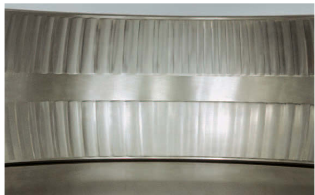
Foto 10.2 Bauteil: Außenring eines Pendelrollenlagers Symptom: Abnutzung der Laufbahn mit einer welligen oder konkav-konvexen Struktur in der Lastzone Ursache: Eindringen von Fremdkörpern bei wiederholten Schwingungen im Stillstand
