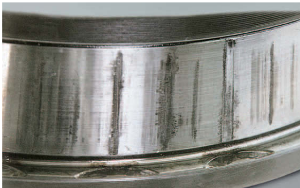
Foto 10.3 Bauteil: Innenring eines zweireihigen Kegelrollenlagers Symptom: Reibverschleiß der Laufbahn und stufenförmige Abnutzung der Bordseite Ursache: Fortschreitendes Fressen durch übermäßige Belastung im Stillstand
