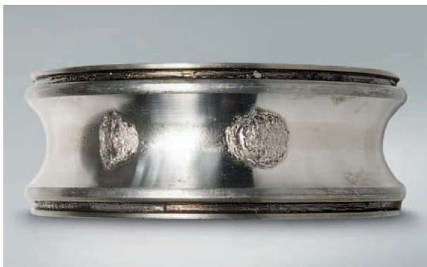
Foto 1.3 Bauteil: Innenring eines Rillenkugellagers Symptom: Abblätterung der Laufbahn im Kugelabstand Ursache: Eindrücke durch Stoßbelastung während des Einbaus
