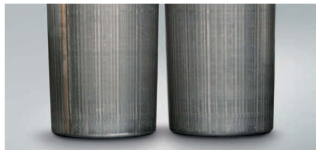
Foto 15.2 Bauteil: Kegelrollen zu Foto 15.1 Symptom: Linienförmige Korrosion auf der Lauffläche
