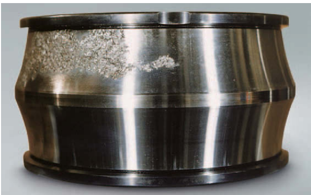
Foto 1.9 Bauteil: Innenring eines Pendelrollenlagers Symptom: Abblätterung nur einer Reihe der Laufbahn Ursache: Mangelschmierung
