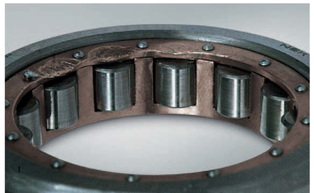
Foto 7.6 Bauteil: Käfig eines Zylinderrollenlagers Symptom: Verformte Käfigscheiben eines Messingmassivkäfigs Ursache: Starke Stoßbelastung während der Montage
