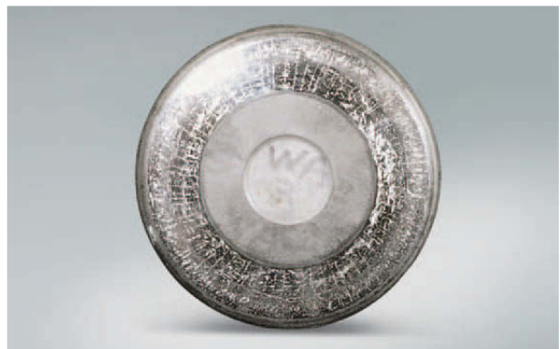
Foto 6.2 Bauteil: Wälzkörper eines Axial-Kegelrollenlagers Symptom: Brandrisse an der großen Rollenstirnfläche Ursache: Überhitzung durch Mangelschmierung im Gleitkontakt zwischen Wälzkörper und Bord
