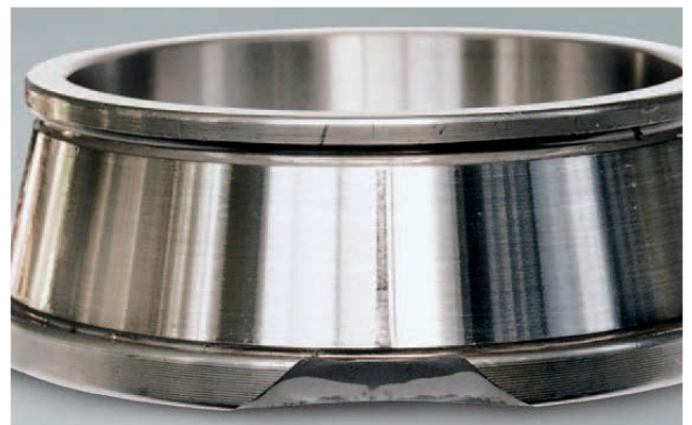
Foto 5.2 Bauteil: Innenring eines Kegelrollenlagers Symptom: Bruch des Innenringbords Ursache: Starke Stöße während des Einbaus
