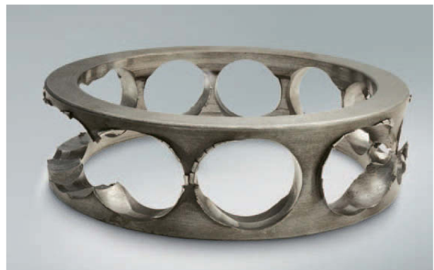
Foto 7.2 Bauteil: Käfig eines Schrägkugellagers Symptom: Gebrochene Stege des Massivkäfigs aus Gusseisen Ursache: Übermäßige Belastung des Käfigs durch einen Fluchtungsfehler zwischen Innen- und Außenring
