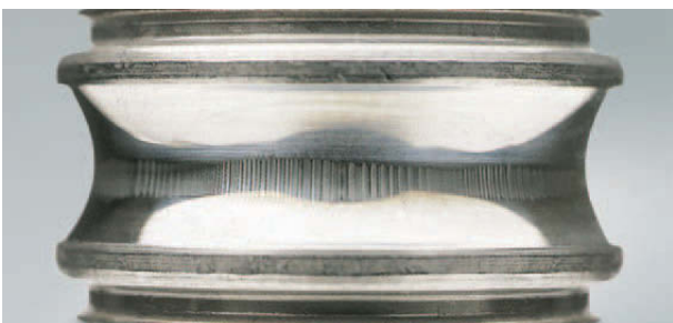
Foto 15.5 Bauteil: Innenring eines Rillenkugellagers Symptom: Riffelungen an der Laufbahn (Durchgang von hochfrequentem Strom)
