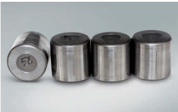
Foto 17.3 Bauteil: Rollen eines Zylinderrollenlagers Symptom: Achsparallele Riefen auf der Lauffläche Ursache: Fluchtungsfehler zwischen Innen- und Außenring bei der Montage
