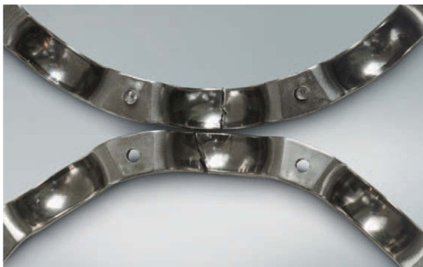
Foto 7.1 Bauteil: Stahlblechkäfig eines Rillenkugellagers Symptom: Gebrochene Käfigtasche
