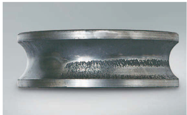
Foto 1.2 Bauteil: Innenring eines Schrägkugellagers Symptom: Diagonale Abblätterung entlang der Laufbahn Ursache: Fluchtungsfehler zwischen Welle und Gehäuse während des Einbaus
