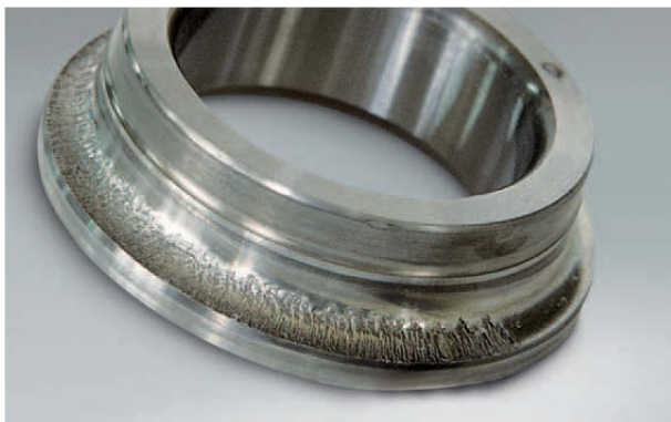
Foto 1.1 Bauteil: Innenring eines Schrägkugellagers Symptom: Abblätterung entlang des halben Laufbahnumfangs Ursache: Mangelschmierung durch Eintritt von Schneidflüssigkeit in das Lager
