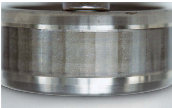
Foto 10.1 Bauteil: Innenring eines Zylinderrollenlagers Symptom: Grübchen aufgrund von Elektrokorrosion, wellenförmiger Verschleiß der Laufbahn Ursache: Elektrokorrosion
