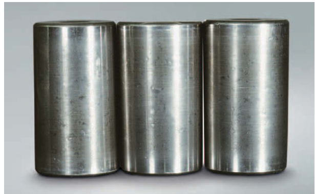
Foto 8.4 Bauteil: Kegelrollen zu Foto 8.3 Symptom: Kleine und große Eindrücke entlang der Lauffläche Ursache: Fremdkörper in die Oberfläche eingedrückt
