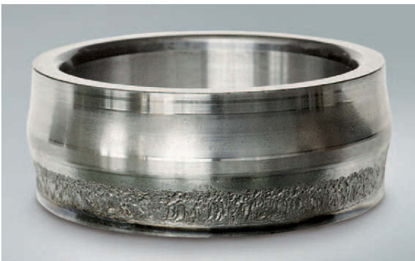
Foto 1.7 Bauteil: Innenring eines Pendelrollenlagers Symptom: Abblätterung an nur einer Laufbahn am gesamten Umfang Ursache: Übermäßige Axialbelastung
