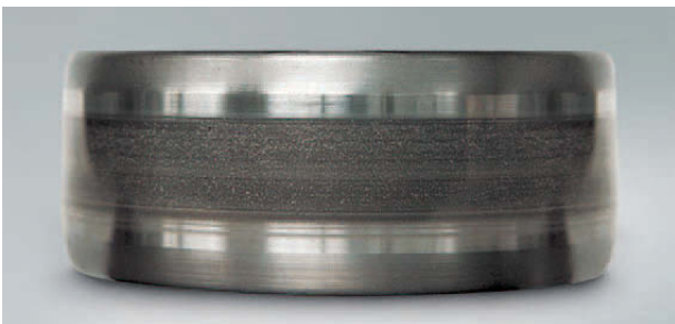
Foto 15.3 Bauteil: Innenring eines Zylinderrollenlagers Symptom: Gürtelförmige Elektrokorrosion in Verbindung mit Grübchen auf der Laufbahn
