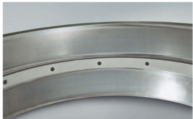
Foto 8.2 Bauteil: Außenring eines zweireihigen Kegelrollenlagers Symptom: Eindrücke in der Laufbahn Ursache: Fremdkörper in die Oberfläche eingedrückt
