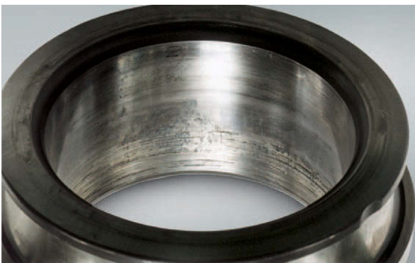
Foto 13.1 Bauteil: Innenring eines Pendelrollenlagers Symptom: Kriechen in Verbindung mit Riefenbildung in der Bohrungsfläche Ursache: Unzureichendes Übermaß
