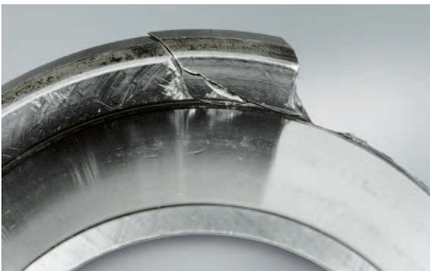
Foto 5.3 Bauteil: Innenring eines Axial-Pendelrollenlagers Symptom: Bruch des großen Bords Ursache: Wiederholte Stoßbelastung
