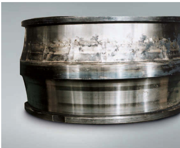
Foto 14.1 Bauteil: Innenring eines Pendelrollenlagers Symptom: Verfärbte oder geschmolzene Laufbahn. Vom Käfig stammende Verschleißpartikel wurden überrollt und haften an der Laufbahn Ursache: Unzureichende Schmierung
