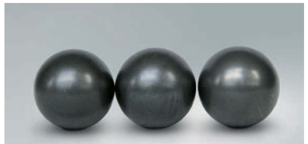
Foto 15.4 Bauteil: Kugeln eines Rillenkugellagers Symptom: Gesamte Kugelflächen durch Elektrokorrosion dunkel verfärbt
