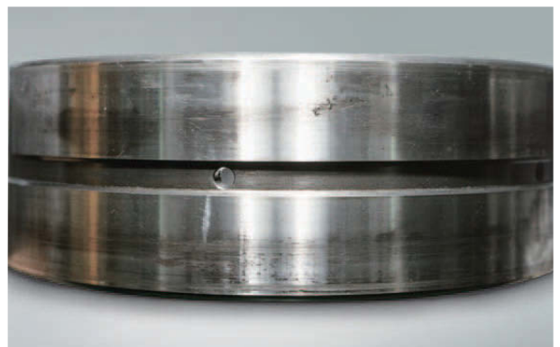
Foto 13.2 Bauteil: Außenring eines Pendelrollenlagers Symptom: Kriechen entlang des gesamten Umfangs der Außenfläche Ursache: Lose Passung zwischen Außenring und Gehäuse
