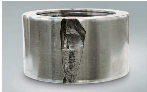
Foto 6.4 Bauteil: Drehender Außenring einer zweireihigen Stützrolle Symptom: Risse in der Außenfläche Ursache: Flächenverschleiß und Wärmeentwicklung durch blockierten Außenring
