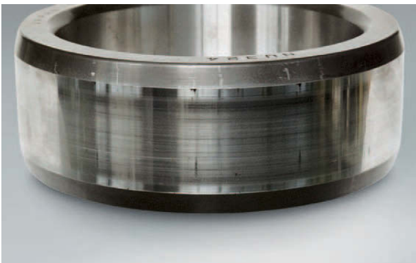
Foto 17.1 Bauteil: Innenring eines Zylinderrollenlagers Symptom: Achsparallele Riefen auf der Laufbahn Ursache: Fluchtungsfehler zwischen Innen- und Außenring bei der Montage
