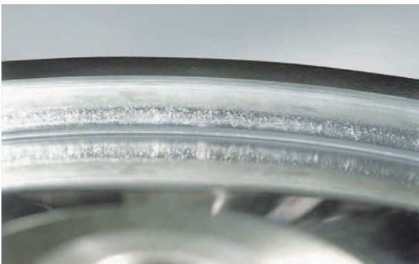
Foto 3.3 Bauteil: Innenring eines Axial-Kegelrollenlagers Symptom: Riefen im Innenringbord Ursache: Verunreinigtes Schmiermittel durch Abrieb sowie gerissener Schmierfilm aufgrund übermäßiger Belastung
