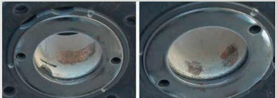
Abb. 37: P2-Gleitlager, Riefen in der Lauffläche
