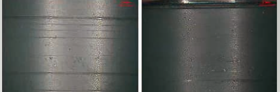
Abb. 37: P2-Gleitlager, Riefen in der Lauffläche
