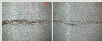
Abb. 36: Schaden durch Erosion in der Einlaufschicht P1-Gleitlager
