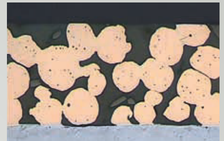
Abb. 5: Beschaffenheit der Gleitfläche am Ende des Einlaufvorgangs
