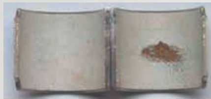
Abb. 35: Örtlicher Schaden durch Kavitation
