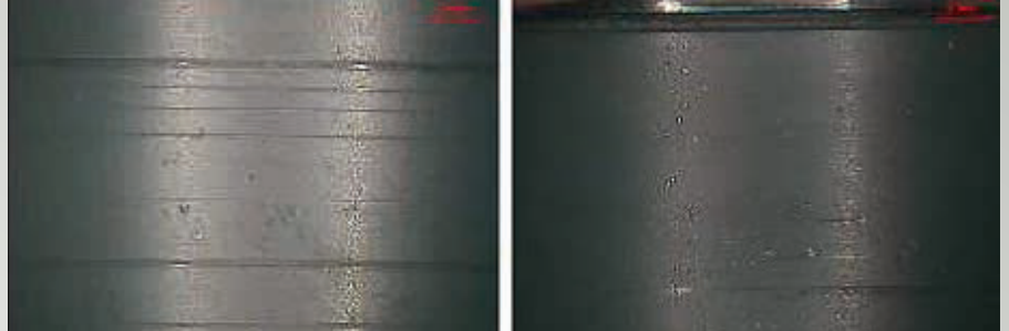
Abb. 37: P2-Gleitlager, Riefen in der Lauffläche
