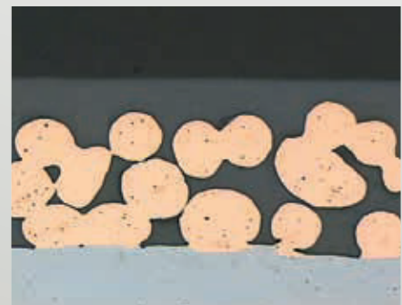
Abb. 4: Beschaffenheit der Gleitfläche im Ausgangszustand
