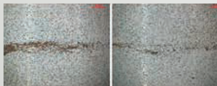
Abb. 36: Schaden durch Erosion in der Einlaufschicht P1-Gleitlager
