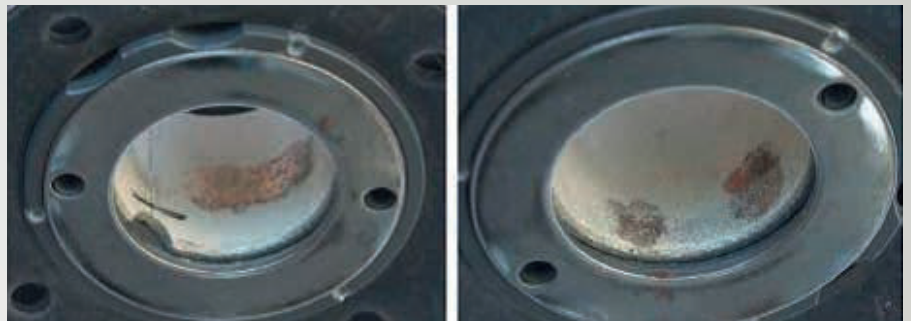
Abb. 37: P2-Gleitlager, Riefen in der Lauffläche
