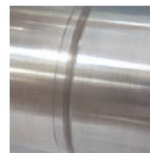
Verschlossene Welle mit Einlaufspur
