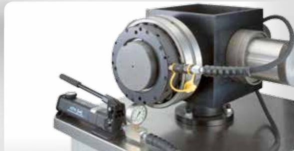
Extraktion der Demontagehülse mit Hilfe der Hydraulikmutter
