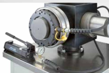
Montage auf Spannhülse mit Hydraulikmutter.
