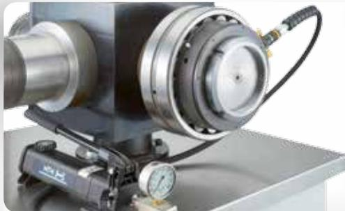
Extraktion der Klemmhülse mit Hilfe der Hydraulikmutter
