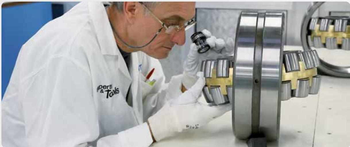
Da in einem Wälzlager alle Parameter zusammenwirken, ist es zwingend erforderlich, die einzelnen Faktoren Stähle, Wärmebehandlung, Geometrie der Wälzlagerkomponenten, Schmierung oder auch Reibung aufeinander abzustimmen, um die bestmögliche technische Lösung zu erreichen.
