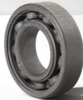
**Die F6XX-Serie**, die für Anwendungen mit besonders hohen Temperaturen (350 °C) und geringen Drehzahlen (max. 50 1/min) ausgelegt ist, wird beispielsweise bei Ofenwagen (für die Herstellung von Porzellan oder Baumaterial), in der Stahlindustrie und Glasindustrie verwendet.
